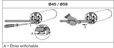
Insérez un tournevis plat adapté au centre jusqu'en butée dans l'orifice de l'étrier enfichable, de manière à ce que ce dernier libère l'ergot du connecteur.
