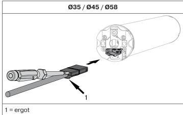
Veillez à **couper la tension** du câble de connexion puis insérez-le dans la tête du moteur jusqu'à ce que vous entendiez l'ergot du moteur s'enclencher. Le cas échéant, utilisez un tournevis plat pour pouvoir enfoncer l'embout plus loin. Placez le tournevis dans l'une des deux fentes prévues à cet effet sur le connecteur.
